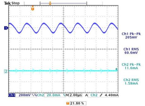
输入电流纹波/输出电压纹波噪声
